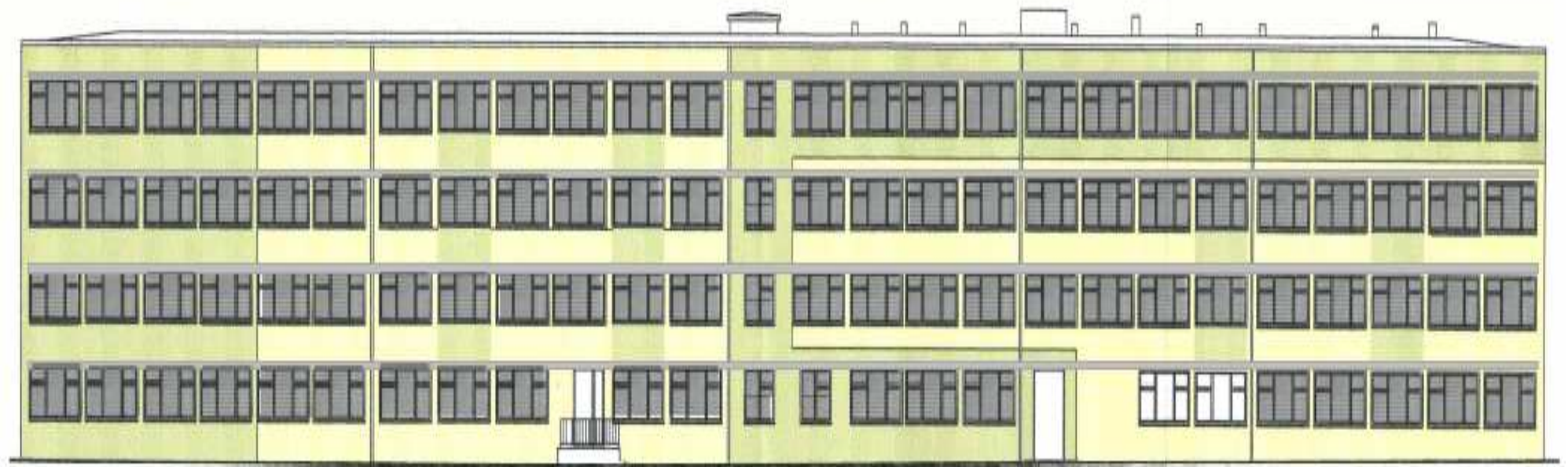
Elewacja wschodnia budynku – okna przewidziane do zabudowy zewnętrznych osłon przeciwsłonecznych
