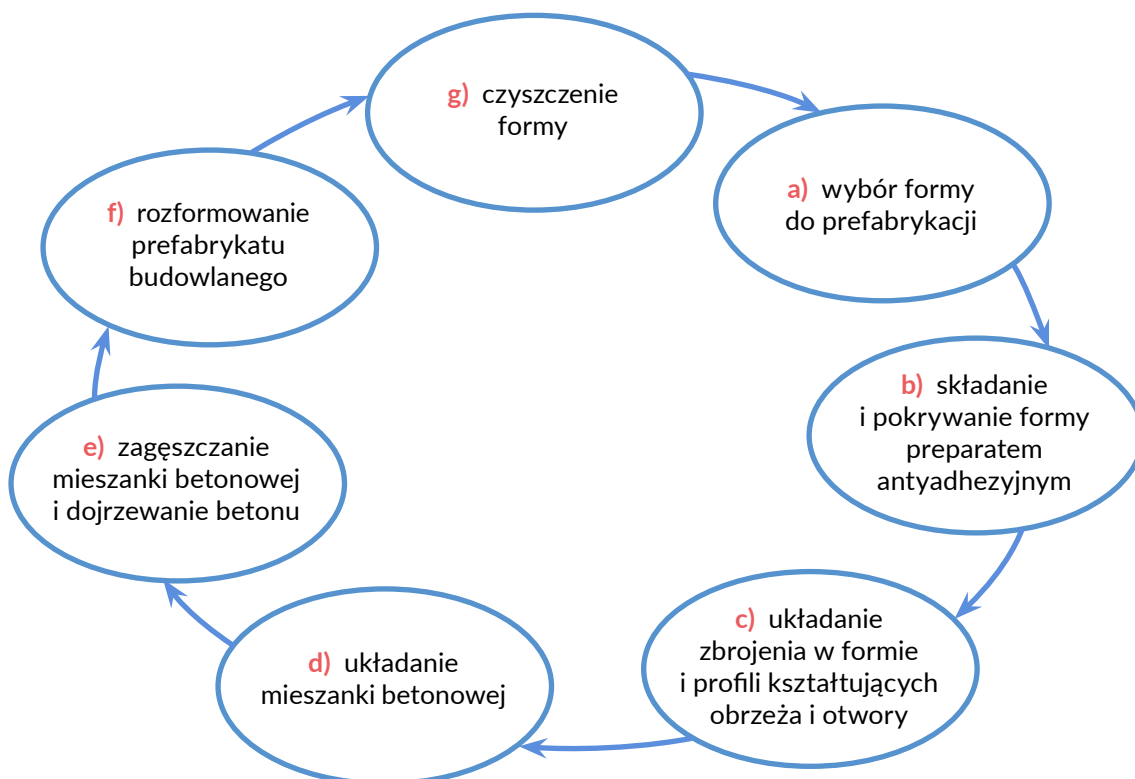
Rysunek 2. Schemat procesu wytwarzania prefabrykatów betonowych
