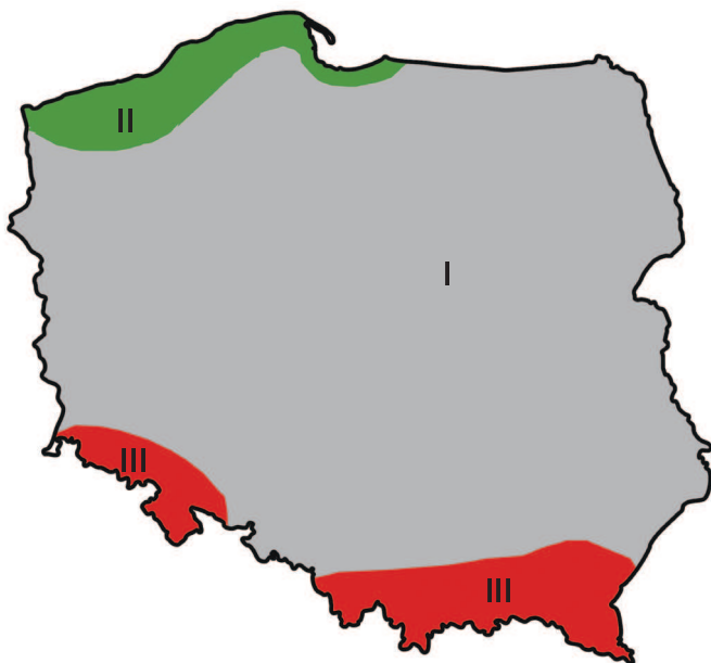
Rys. 18. Strefy obciążenia wiatrem wg normy PN-B-02011:1977/Az1:2009 oraz PN-EN-1991-1-4:2008.
