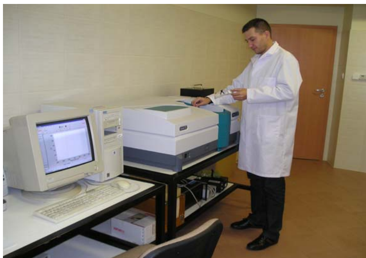
Rys. 6.2 Widok stanowiska pomiarowego wyposażonego w spektrofotometr typ Cary 5000
