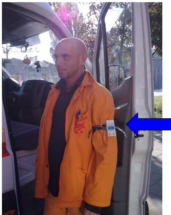
Rys. 7.1 Przykład zamocowania dozymetrów na ramieniu pracownika (na dozymetrze elektronicznym naklejony jest film polimerowy dozymetru fotochromowego)
