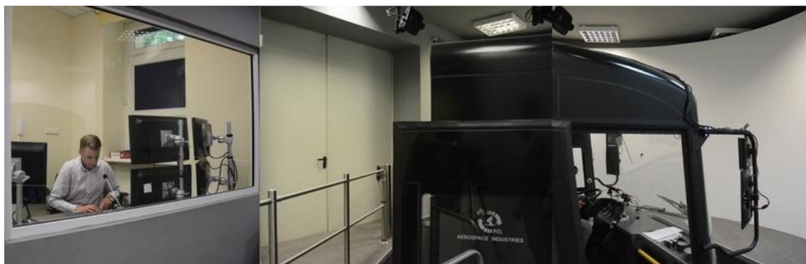
Fot. 1. Kabina symulatora autobusu AUTOSAN 1010T LIDER i widok na stanowisko operatora
