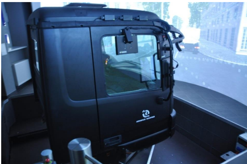
Fot. 2. Kabina symulatora samochodu ciężarowego/ciągnika siodłowego Mercedes Benz Actros
