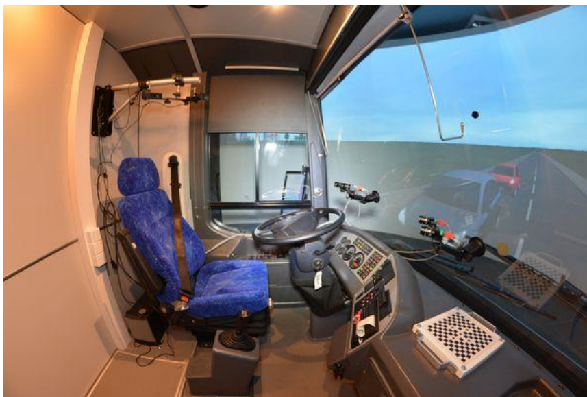
Fot. 3. Wnętrze kabiny symulatora autobusu AUTOSAN 1010T LIDER
