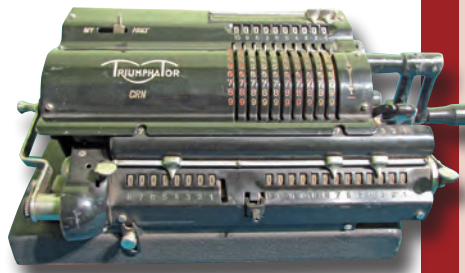
Arytmometr (mechaniczna maszyna licząca) Triumphator. Zbiory ZUS, I Oddział w Poznaniu
