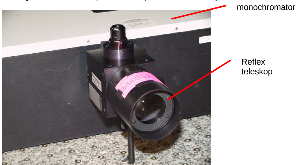
Rys. B1.10. Widok Reflex Teleskopu - układu wejściowego systemu spektrometrycznego do pomiaru luminancji energetycznej [fot. zbiory autorów]
