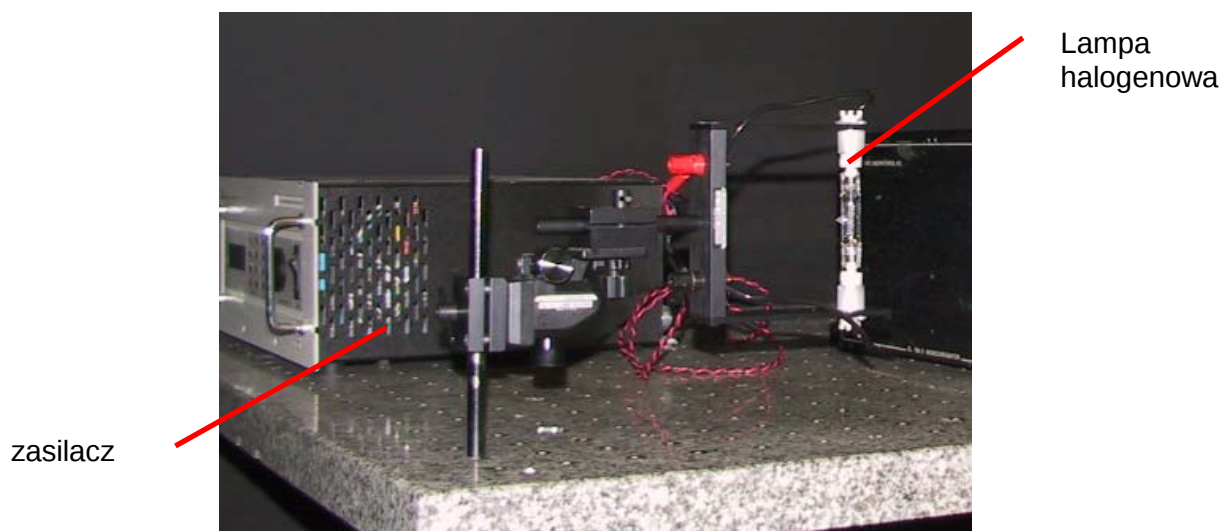
Rys. B1.9. Widok wzorcowej lampy halogenowej OL 200IR podłączonej do zasilacza OL 83A [fot. zbiory autorów]
