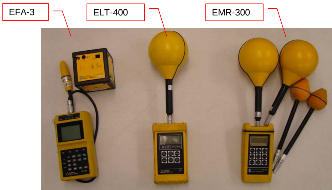
Rys. B.1.15. Aparatura do pomiarów zmiennych pól elektromagnetycznych - mierniki typu EFA-3, ELT-400, EMR-300 [fot. zbiory autorów]
